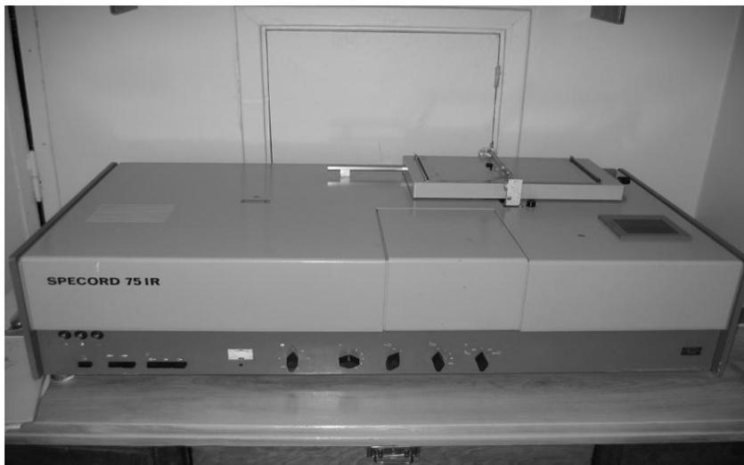
Рис.3. Общий вид спектрофотометра SPECORD 75IR.
